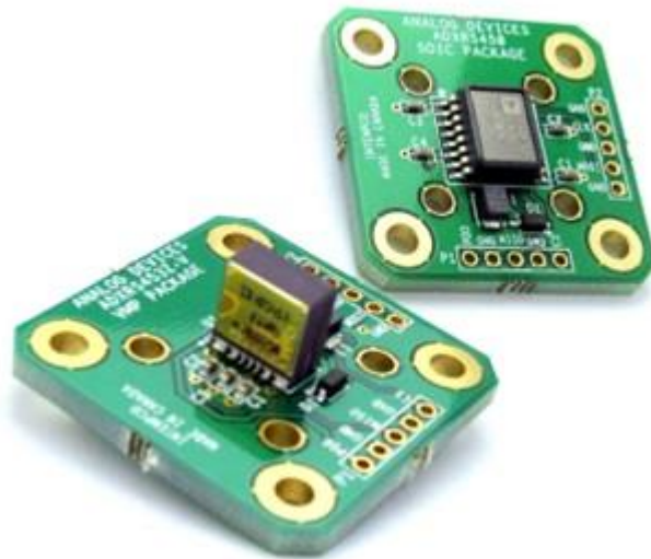
Obr. 5.8. – jednoosový gyroskop s elektronikou [5.5]
